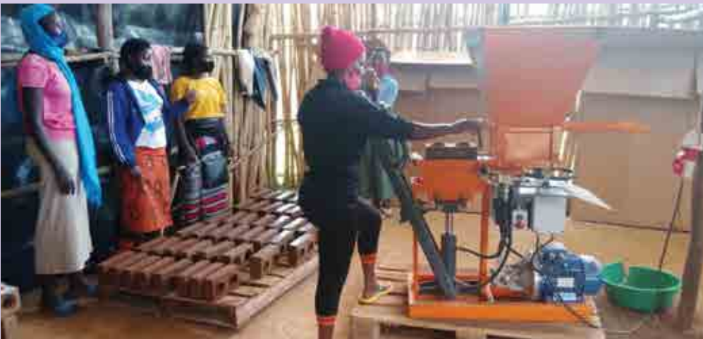
Učenje izdelave kvalitetnih opek s prešami, ki jih je kupilo podjetje Damahaus in Ministrstvo za zunanje zadeve RS domačinom v Ruandi, da bodo lažje preživeli z zaslužkom in imeli bolj trdno grajene hiše.
