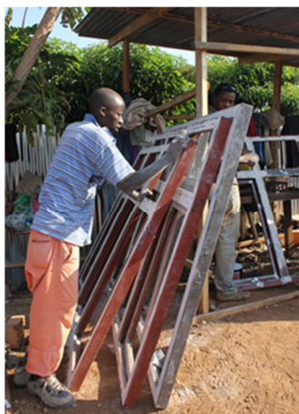
Varjenje železne konstrukcije za okna in vrata ter za konstrukcijo za streho za šolo.
